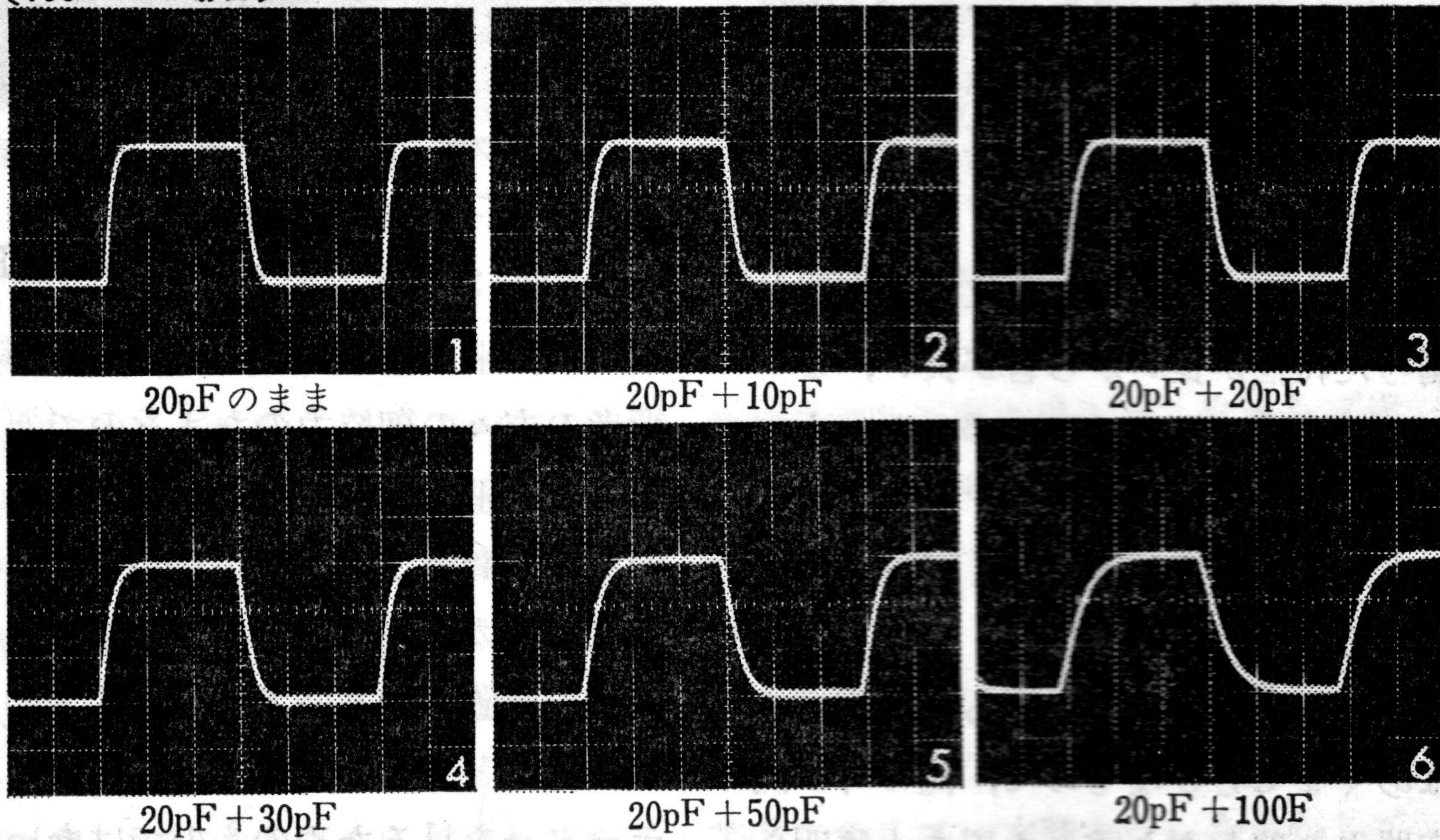
[写真3] クリスキットP-35のC-4 (20pF) とパラレルに、10pF, 20pF, 30pF, 50pF及び100pFを足して行った時の10kHz及び100kHzでの方形波の応答
