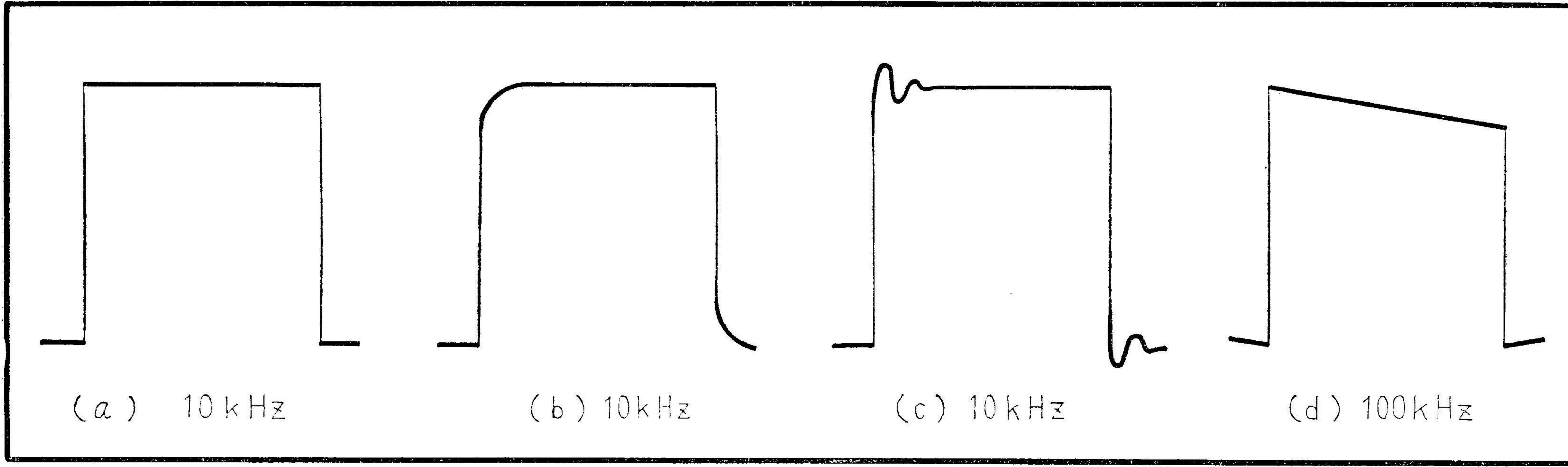
〔第10図〕 オシロスコープによる方形波の観察 (a)正確な波形で横線が出来るだけ真直ぐで、縦の線はほとんど見えないのが良い。(b)左肩が丸みを帯びて下っていると、高域の特性が下っている。(c)左肩にオーバーシュートやリングキングがあると、高域特性にあばれがある。(d)右肩が下っているのは、低域が下っている事を示している。
