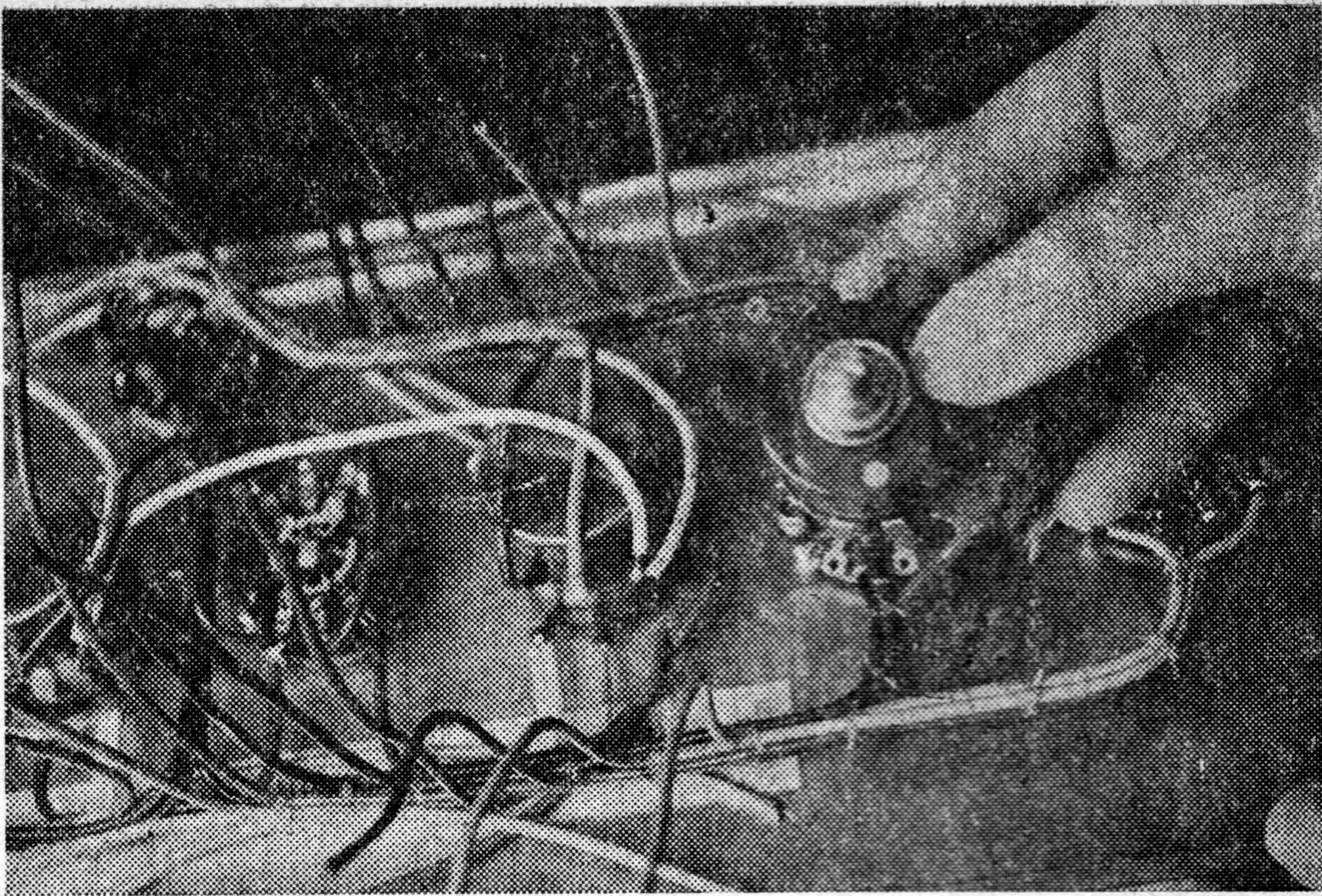
〔写真5〕 写真の右側のもののように端子が同一方向に出ていると、下側の配線がボリューム本体の上を越えて配線しなければならぬので感心しない。その点、左のような（手で持ったもの）ボリュームを使うと配線がスッキリとできる。
