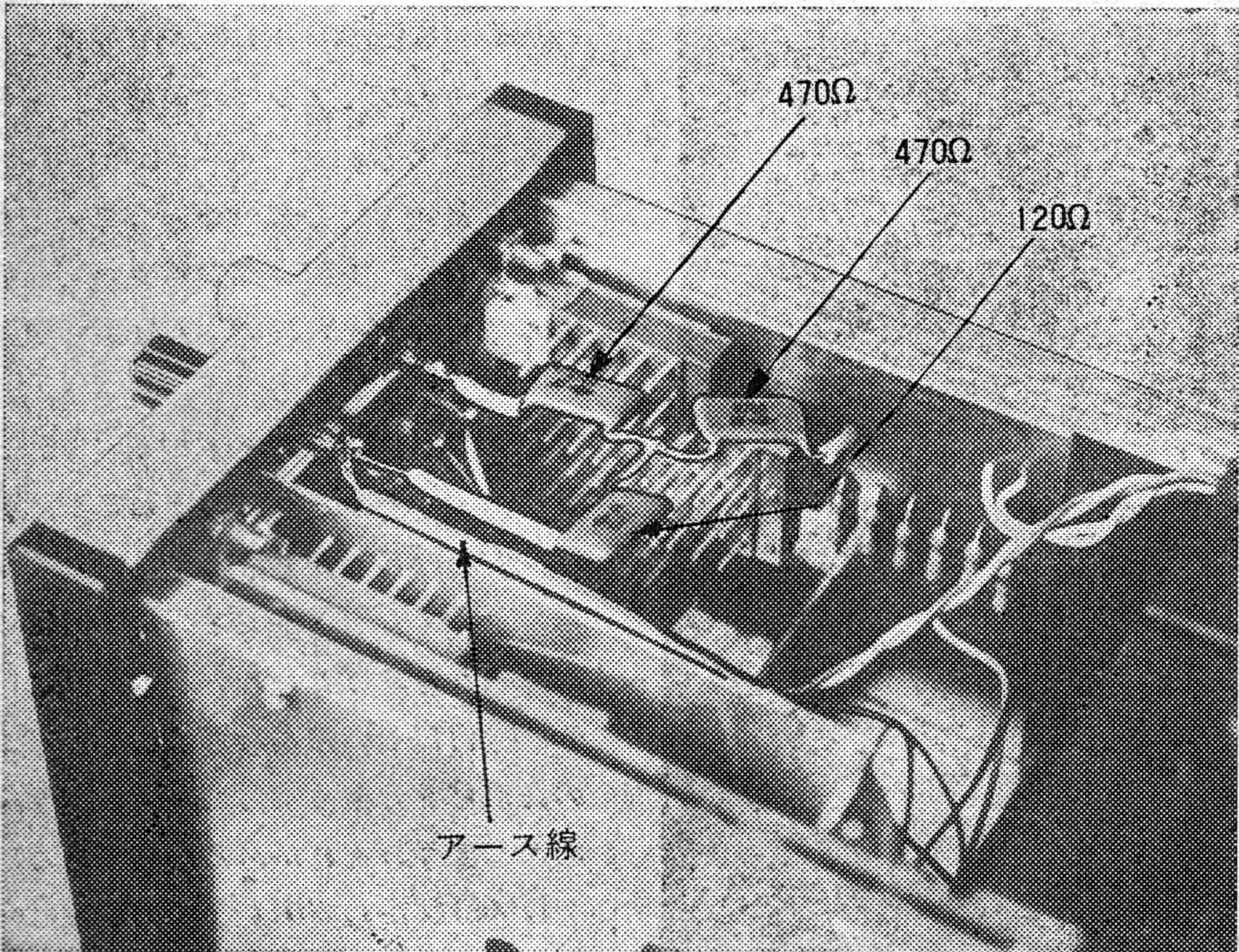
3つのネジをはずすと、測定器本体をケースからうしろへすっぽりと、抜き取ることができる。次に、出力端子に金属被膜抵抗を使った減衰器を入れる（抵抗値の大きさは74年3月号第7図を参照）
